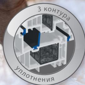
**3** Три контура уплотнения повышают герметичность окна. При этом гибкое среднее уплотнение в фальце рамы является решающим для теплоизоляции, так как оно уменьшает тепловой поток в районе фальца.
