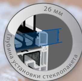
**4** Более глубокая установка стеклопакета в створку улучшает теплоизоляцию и снижает риск выпадения влаги на окне.
