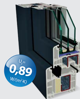
Hoher Rahmen mit Flügel in Farbe und bestätigter ift-Passivhaustauglichkeit
