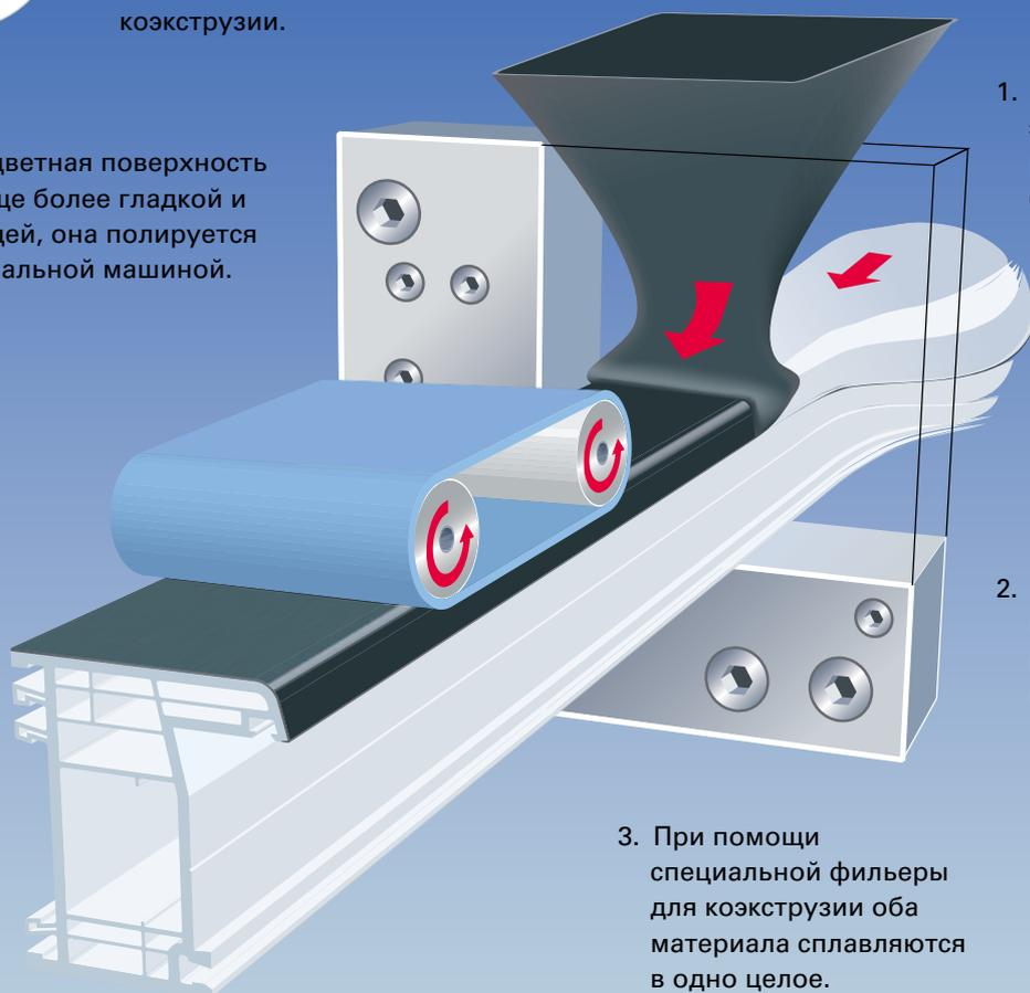
1. Через основной экструдер поступает расплавленная масса белого ПВХ.
