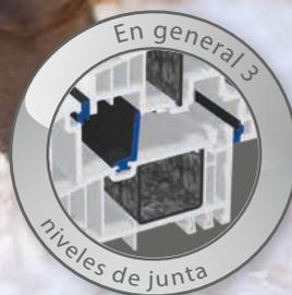
**3** Concepto inteligente de estanqueidad con 3 niveles de junta en general. En ello la junta central flexible en el galce de marco contribuye decisivamente al aislamiento térmico, ya que reduce el flujo de calor en la parte del galce.
