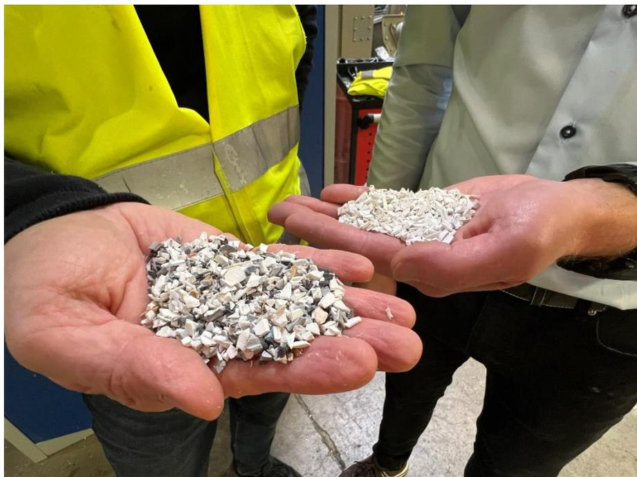
Altfenster und eigener Produktionsausschuss werden zerkleinert, sortiert und wieder in Profilen verarbeitet (Foto: GEALAN)
