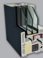
okno GEALAN-KUBUS® z ukrytym skrzydłem głębokość 82,5 / 101 mm Uf = 0,88 W/m²K
